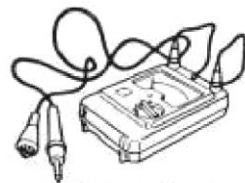
tester izolačního odporu (tester Megger)
