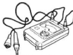
Измеритель сопротивления изоляции (тестер Megger)
