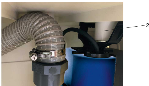
Obr. 17: Správná montážní poloha víka a čerpacího agregátu
